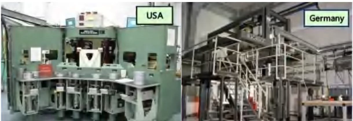
图 36：美国和德国的六维力传感器标定及检测设备示意图
