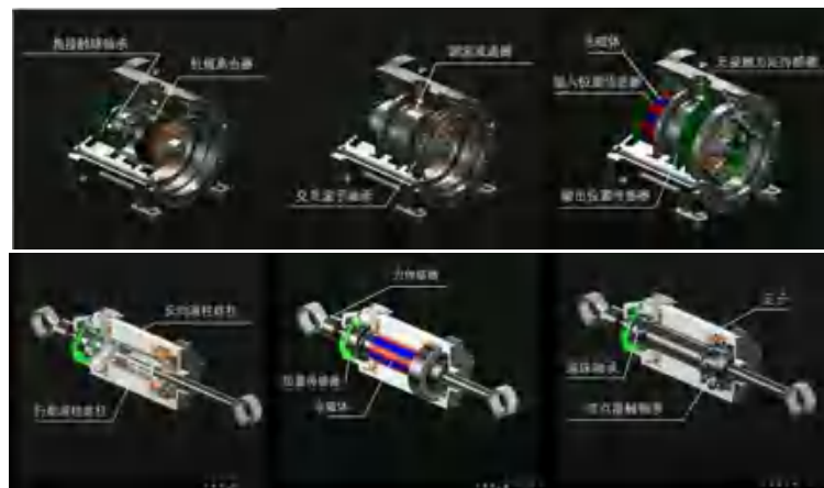
图 29：特斯拉人形机器人采用的旋转和线性执行器示意图
